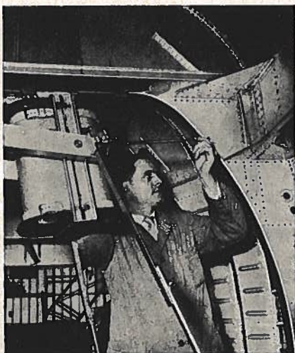
Röntgenonderzoek van klinkverbindingen in een vliegtuig.
